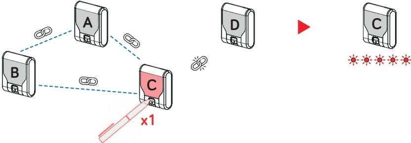
1/ Effectuez un **appui connect** sur un récepteur appartenant au réseau existant, celui-ci clignote rapidement indiquant qu'il ouvre son réseau.
