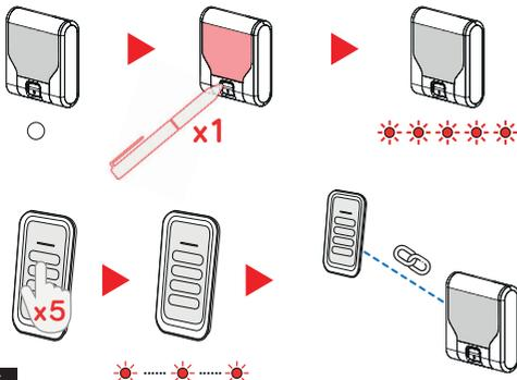
Le récepteur **appartient à un réseau** puisque la **LED est éteinte**. Effectuez un **appui connect** sur le récepteur. Celui-ci va clignoter rapidement indiquant qu'il ouvre son réseau.
