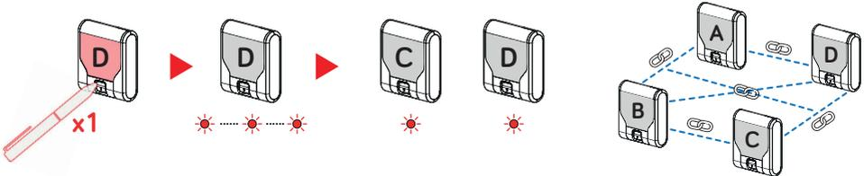
2/ Effectuez un **appui connect** sur le(s) récepteur(s) que vous souhaitez ajouter au réseau existant, celui-ci clignote lentement indiquant qu'il cherche le réseau.
